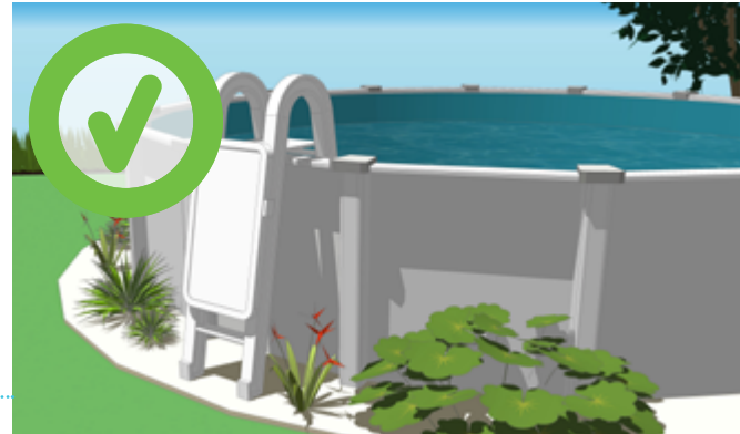
Exemple d'échelle munie d'une portière de sécurité.
